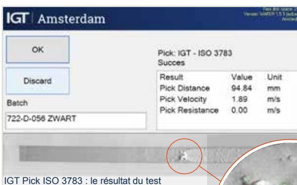
IGT Pick ISO 3783 : le résultat du test
