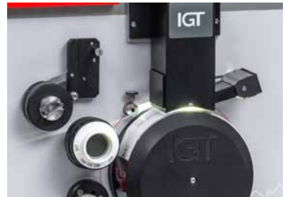
IGT Pick ISO 3783: die Kamera beim Scanvorgang
