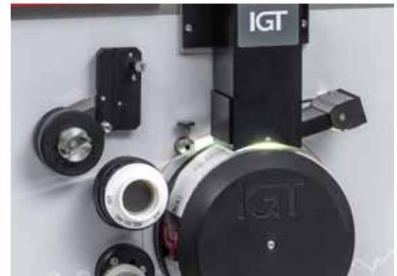
IGT Pick ISO 3783 : la caméra est en train de scanner
